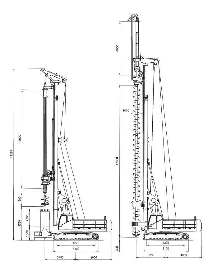
Perforatrice idraulica per pali Hydraulic piling rig
